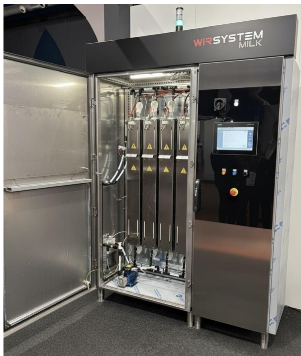
Figura 3. Impianto per il trattamento a raggi infrarossi (WIR System).
