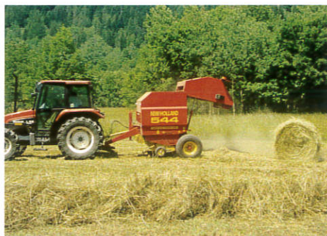
Rotopressa: prestare attenzione al momento dello scarico nelle superfici in pendenza
