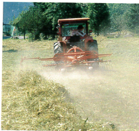
Perdite meccaniche: dovute all'errata regolazione dell'attrezzo (giro-andanatore) e alla velocità di avanzamento elevata
