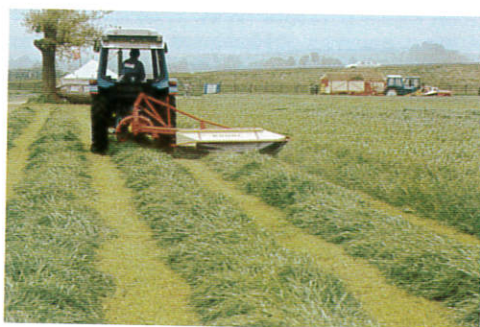
Falciatrice rotativa a tamburi: forma direttamente andane e quindi si deve subito arieggiare il foraggio
