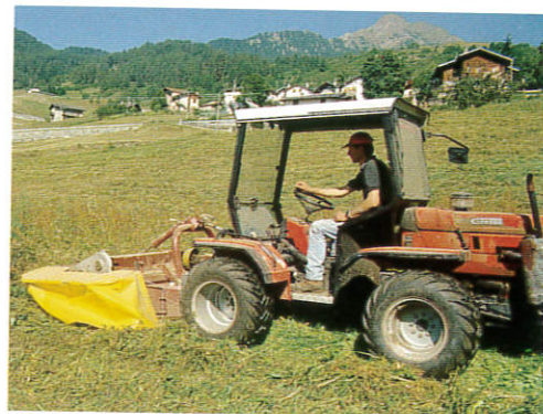
Le falciacondizionatrici con attacco frontale evitano il calpestamento dell'erba nell'apertura del campo
